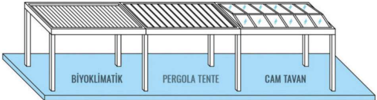
KENDİNDEN AYAKLI KÖŞE BİRLEŞİM ELEMANLARIYLA KURULMUŞ MODÜLER ÇOKLU SİSTEM (BİYOKLİMATİK, PERGOLA, CAM TAVAN) MODULER MULTI UNIT FREE STANDING SYSTEM WITH CORNER CONNECTION ELEMENTS (BIOCLIMATIC, PERGOLA, GLASS ROOF)
